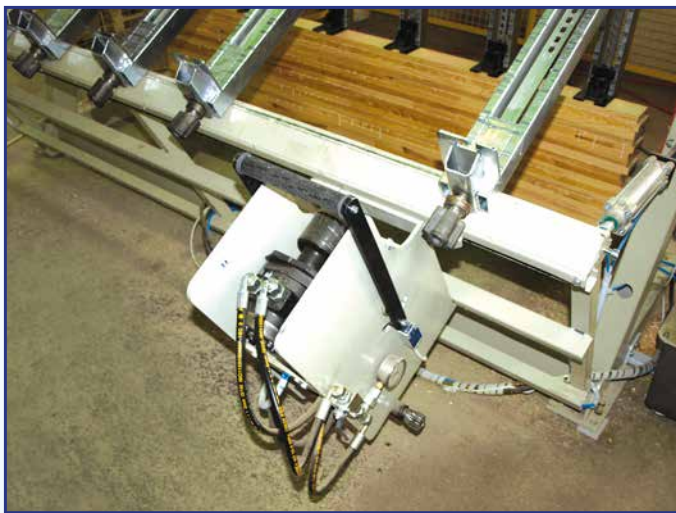
Carriage with hydraulic motor Wagen mit dem Hydraulikmotor Carrello con motore idraulico Engin avec un moteur hydraulique Carro con motor hidraluico
