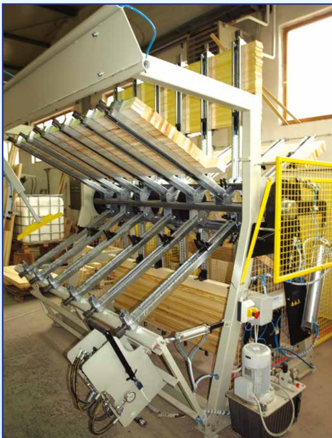
Pneumatic rotation and pressing with hydraulic motor Pneumatische Rotierung und Drücken mittels Hydraulikmotor Rotazione pneumatica dello strettoio e pressatura con l'aiuto del motore idraulico Mouvement de rotation et de compression à l'aide d'un moteur hydraulique movimiento neumático de la prensa y prensado a motor hidráulico
